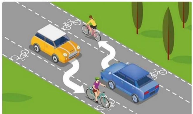
Notre commune va se voir très prochainement équipée d'une chaussée à voie centrale banalisée, plus simplement appelée « Chaussidoux », qui est un aménagement routier doté d'une voie unique et utilisable à double sens pour les véhicules, et bordée de chaque côté par un espace matérialisé au sol permettant aux piétons et cyclistes d'utiliser la route en sécurité.
